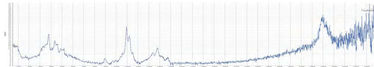
Abbildung 4: RAMAN-Spektrum Papier 309 - Sulfitzellstoff (Buche, gebleicht) Zewa-Weißbuche 92,2% GE.
